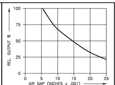
FIG. 2 TYPICAL OUTPUT/AIR-GAP
